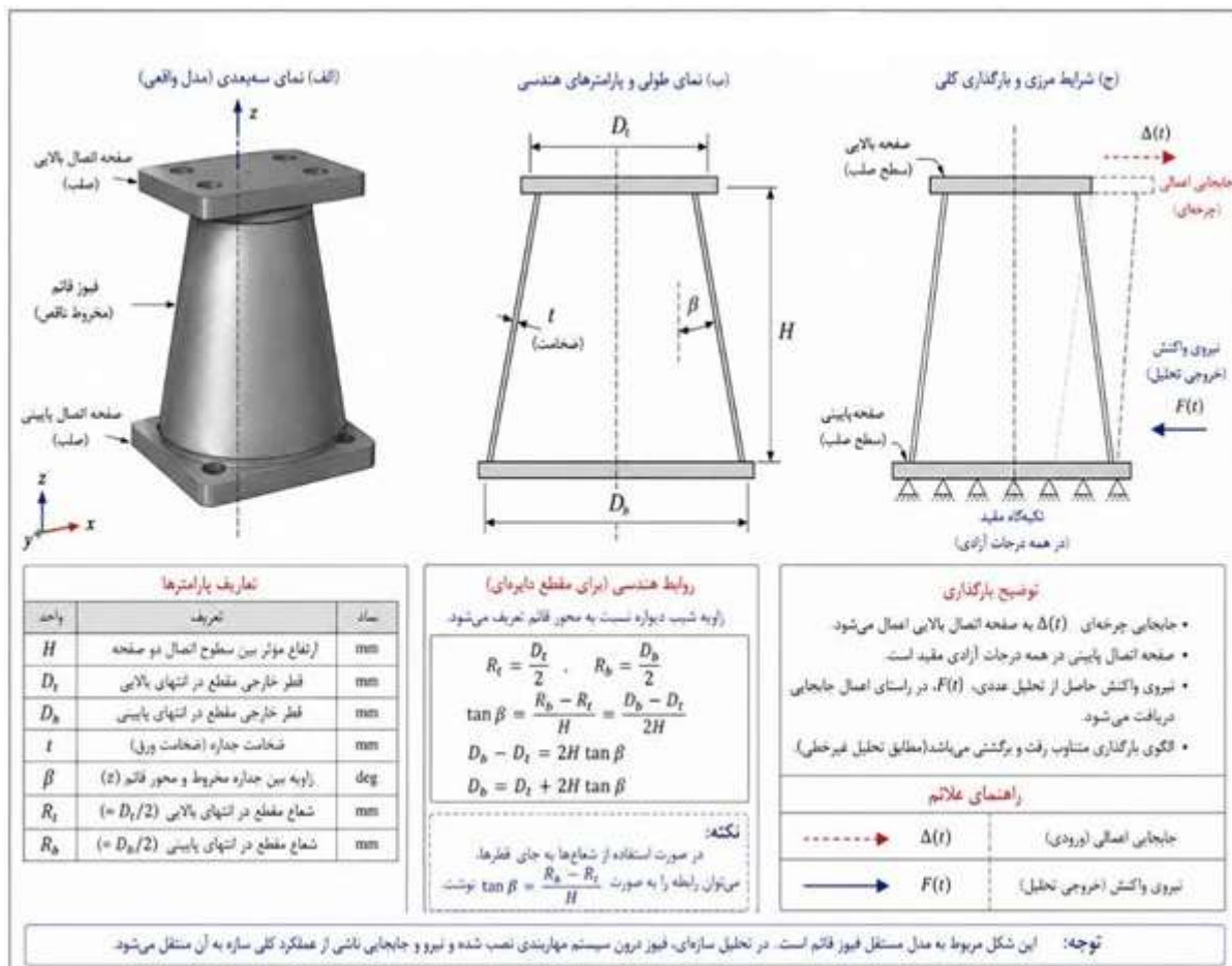
شکل ۱. هندسه شماتیک لینک قائم با مقطع متغیر هرم ناقص و پارامترهای هندسی
